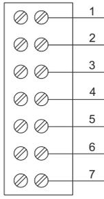
1. Sensor 1 [spannungslos] (blau) 8 VDC (-)
